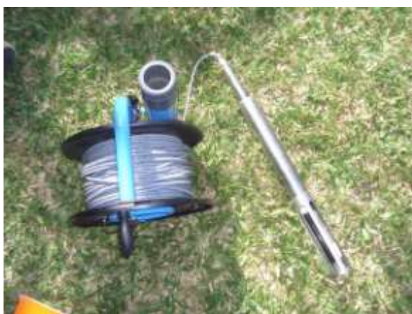
Foto 4.5 La sonda multiparametrica utilizzata nella campagna di misurazioni (Mbezi Beach, Prof. Hayuma)
